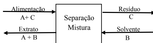
Figura 2.1 – Representação esquemática do processo de extração: A – Solute, B- Solvente, C-Diluente. [Adaptado de Muller et al. (2012)]
