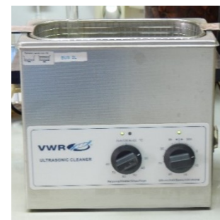
Figura 3.3 – Banho de ultrassons da VWR utilizado na dissolução dos NFs.
