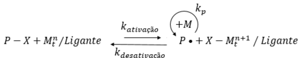
Figura 19 - Representa esquemática do equilíbrio dinâmico alcançado entre espécies ativas e dormentes em ATRP [35-37].
