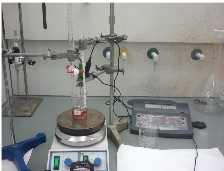
FIGURA 3.2: Instalação laboratorial para acidificação de glicerol bruto, similar ao ensaio de neutralização.
