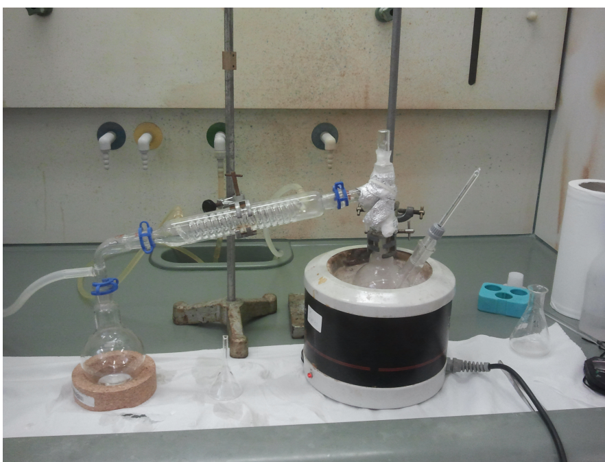
FIGURA 3.3: Instalação laboratorial de destilação a vácuo.
