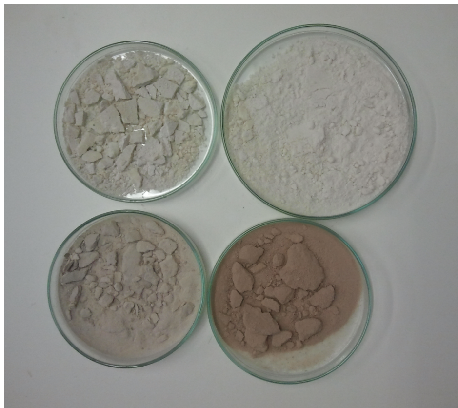
FIGURA 4.16: Aspeto dos sólidos precipitados filtrados e secos para os dois ácidos, H_3PO_4 amostras do topo, H_2SO_4 amostras do fundo, de lado direito estão os sais removidos após acidificação e de lado esquerdo sais removidos após a neutralização.
