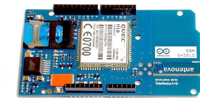
Figura 20 – *Shield* GSM Arduino.
