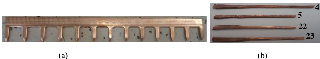
Fig. 15 – Chapa de cobre usada para curto circuitar as lâminas do núcleo estático: (a) chapa original; (b) chapa após o rearranjo em função da dimensão da ranhura correspondente.
