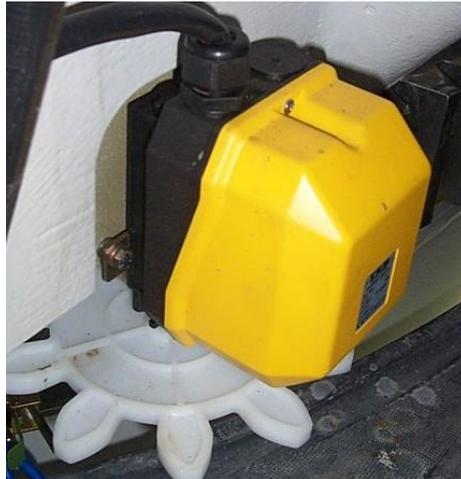
**Figura 4.16 - Encoder yaw - sensor de torção dos cabos**
