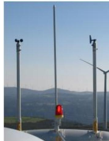
**Figura 4.17 - Sensores de velocidade e direção do vento**
