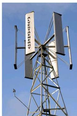
Figura 1.5 - Turbina eólica de eixo vertical - *Darrius*
