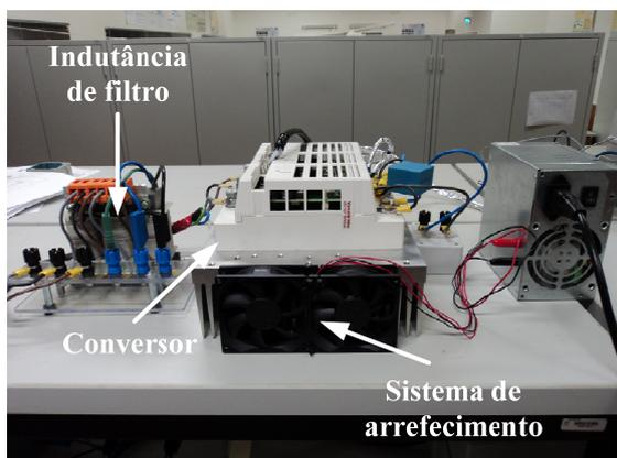
**Fig. B.5 – Conversor que alimenta o rotor da MIDA com a indutância de filtro.**
