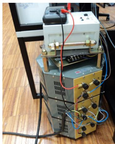
**Fig. B.4 – Autotransformador que liga ao estator quando existe as condições necessárias.**
