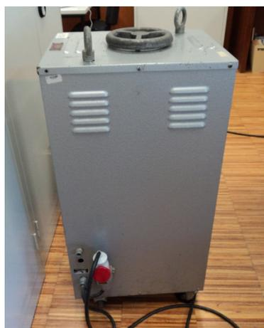
**Fig. B.3 – Autotransformador que alimenta o barramento DC.**
