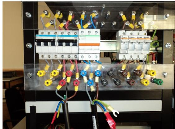
**Fig. B.6 – Proteção do estator e do rotor contra sobrecorrentes.**
