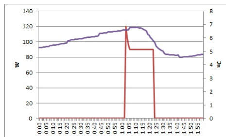
Figura 2.4: Ciclo ON/OFF de um frigorífico, Potência pedida a rede (Vermelho), Temperatura Interior (Roxo)
