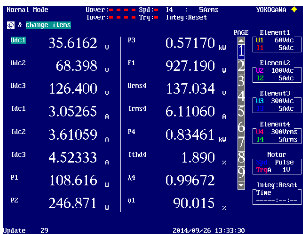
Figura 4.10 - Medidas do sistema ligado à rede sem conversores DC-DC
