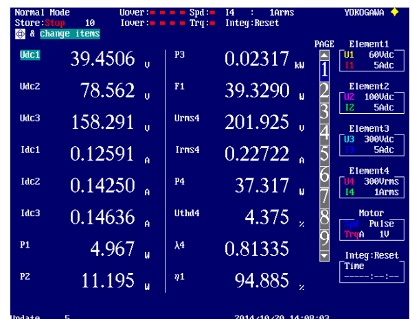
Figura 4.6 - Medidas com o carregador de baterias
