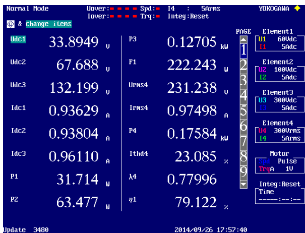
Figura F.6 - Medidas do sistema ligado à rede sem conversores DC-DC
