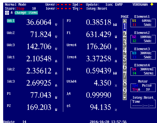
Figura 4.4 - Medidas com uma carga resistiva de 50\Omega
