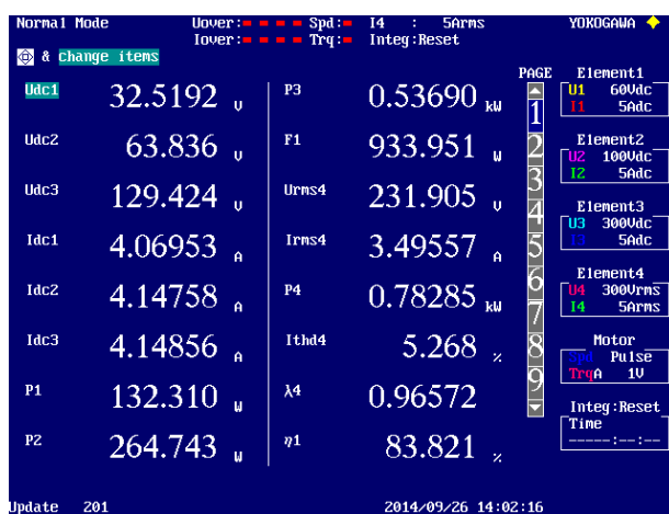
Figura 4.14 - Medidas do sistema ligado à rede com conversores DC-DC
