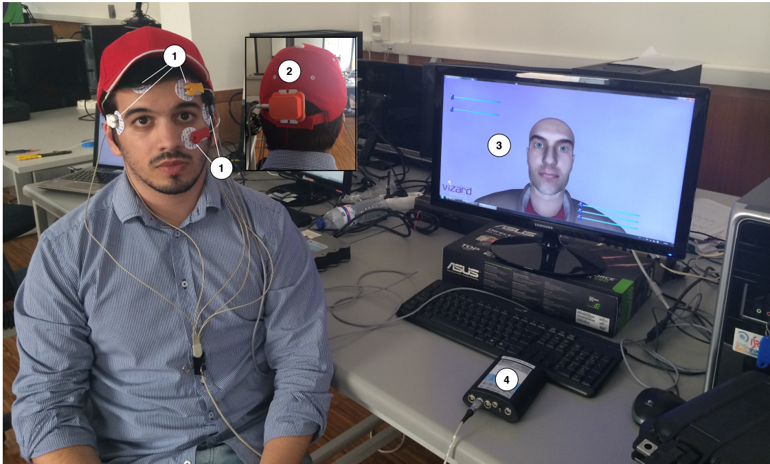
Figura 4.2: Fotografia do setup experimental do sistema EOG. (1) Eléctrodos; (2) IMU; (3) Avatar; (4) g.MOBIlab+.
