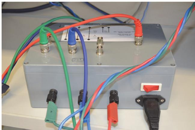
**Fig. 47 - Circuito de medição e acondicionamento de sinais.**
