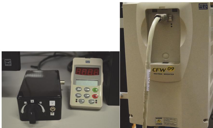
**Fig. 48 - Controlador e respectivo variador eletrônico de velocidade.**
