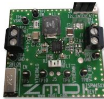
(b) Solução MPPT comercial ZSPM4523 do fabricante ZMDI;
