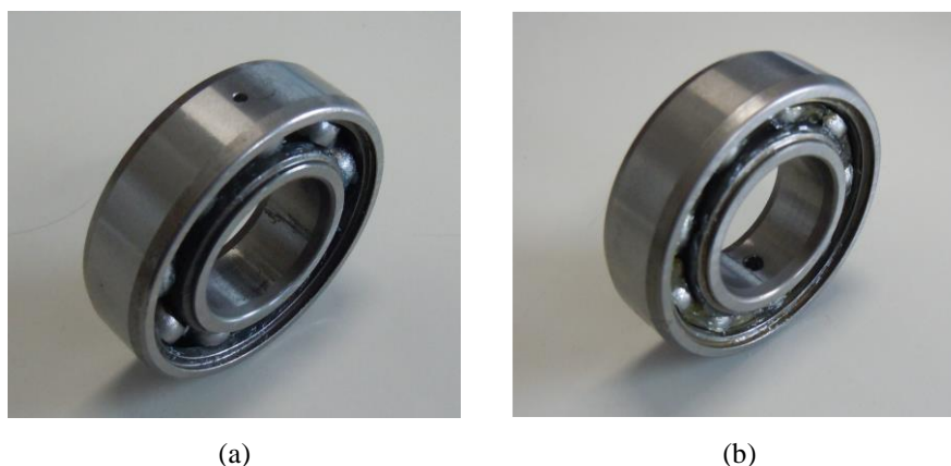
Fig. 4.2 – Rolamentos com avaria: (a) furo de 2 mm no anel externo; (b) furo de 4 mm no anel interno.
