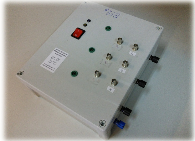
Figura D.12 – Sensor trifásico de tensão e corrente, usado para monitorizar as tensões do conversor e correntes de linha.
