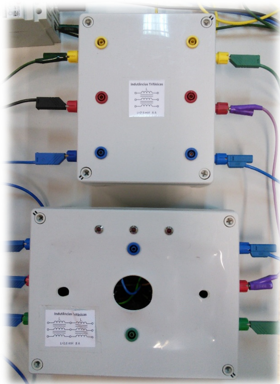
Figura D.15 – Associação em série de indutâncias, possuem o valor aproximado de 8,47 mH (valor obtido com medidor LCR).
