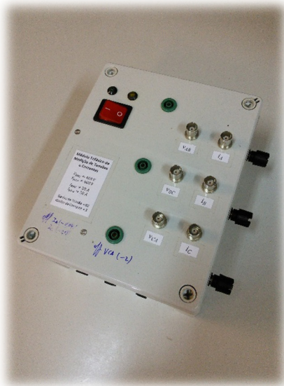
Figura D.11 – Sensor trifásico de tensão, usado para monitorizar as tensões de entrada.
