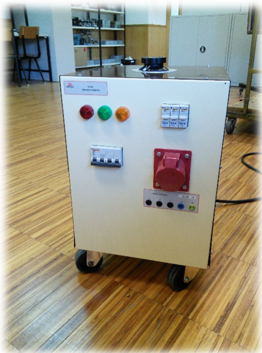
Figura D.16 – Autotransformador usado para regular a tensão de alimentação do retificador.
