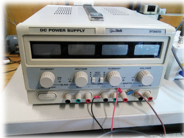
Figura D.18 – Fonte DC usada para alimentar a placa de distribuição de sinais da fase C e o sensor de corrente da carga.
