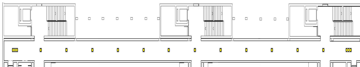
Figura E. 2 - Planta com a nova distribuição dos focos de iluminação LED dos corredores dos pisos 0 e 1
