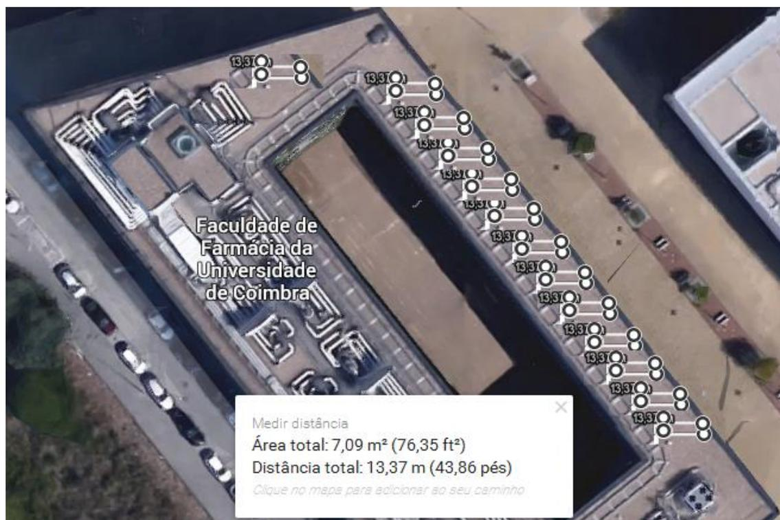
**Figura G.1** – Representação da instalação de 13 conjuntos de 5 painéis solares na cobertura do edifício da Faculdade de Farmácia (cada conjunto com a área indicada).
