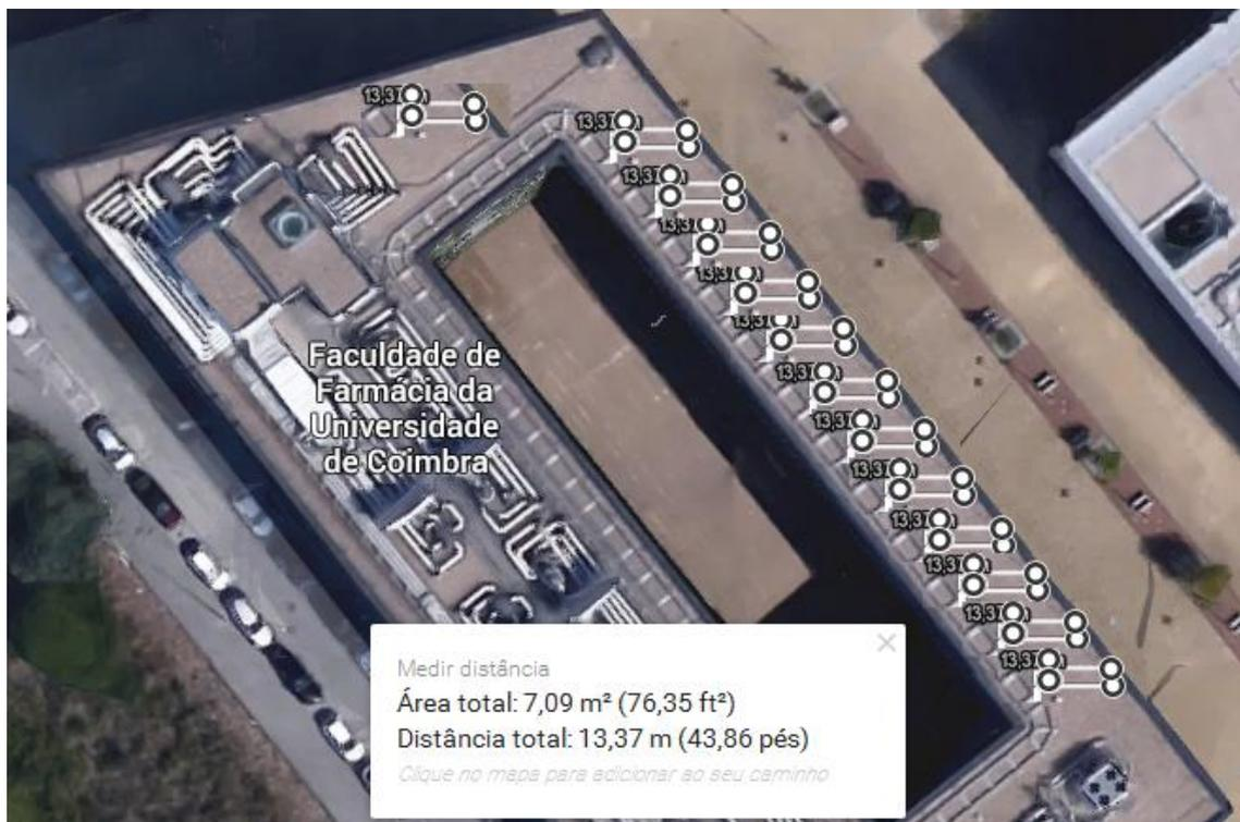
*Figura 13 - Representação da instalação de 13 conjuntos de 5 painéis solares PV na cobertura da FFUC (cada conjunto com a área indicada).*
