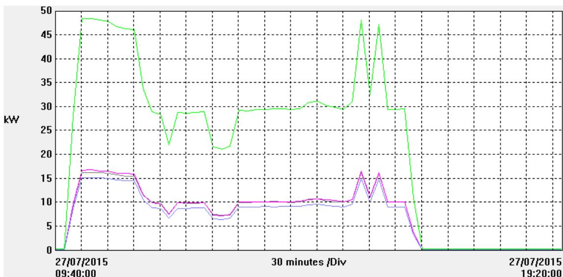
**Figura C.4** – Diagrama de carga do *chiller* 1 com controlo.
