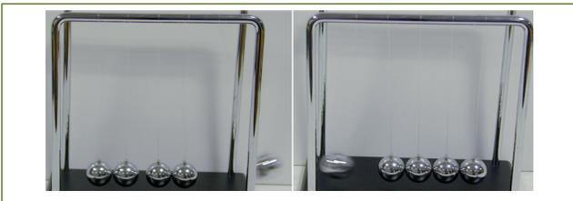
**Figura 7.** *Cuna de Newton*. Fue inventada por Willen J. Gravesande (1688-1742) para estudiar la física de los choques. Las leyes de conservación del momento lineal y de conservación de la energía mecánica, implican que si una, dos, tres, etc., bolas son separadas hasta una cierta altura y luego dejadas caer, una, dos, tres, etc., bolas, respectivamente, serán desplazadas del otro lado de la cuna.
