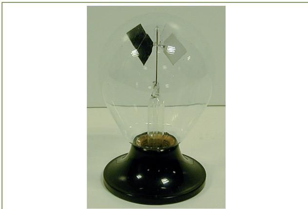
**Figura 17. Radiómetro de Crookes.** El radiómetro no funciona debido a la presión de radiación, la idea original de Crookes al construirlo, sino debido a un mecanismo de choques contra los bordes de los rombos, por lo que se necesita una pequeña cantidad de aire a baja presión. Si hubiera demasiado aire, el rozamiento haría que se detuviera el giro de las paletas.
