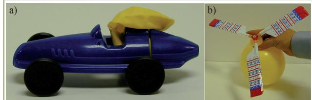
**Figura 9.** (a) *Coche movido por globo*. Vehículo movido por un globo hinchado unido a él que se deshincha a través de un orificio. (b) *Helicóptero de globo*. El giro del helicóptero es producido por el globo al deshincharse a través de un distribuidor que envía el aire a través de sus alas, con contienen un tubo hueco con un codo. Para permitirle ascender, sus alas tienen una cierta inclinación respecto de la horizontal.
