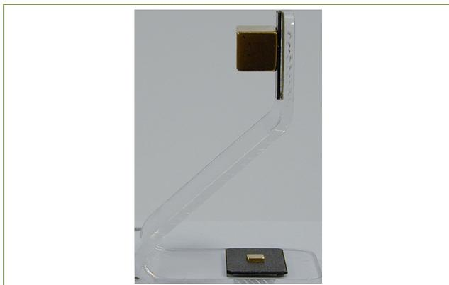
**Figura 24.** *Levitador diamagnético*. Sobre una capa de grafito pirrolítico flota un pequeño imán plano al inducir un campo magnético opuesto en el material diamagnético. En la parte superior se encuentra un gran imán cúbico que compensa en parte la fuerza de la gravedad sobre el pequeño imán. A diferencia de lo que sucedería con una configuración de sólo imanes, éste equilibrio es estable.
