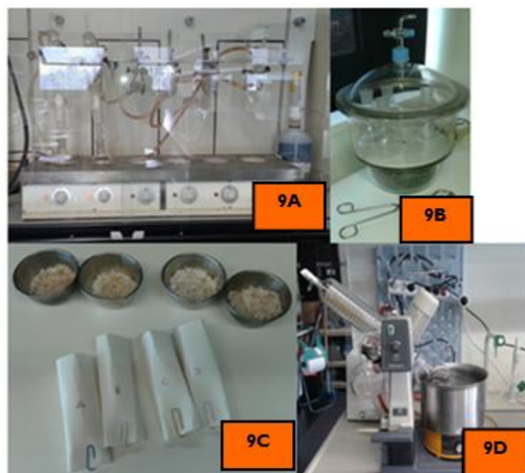
Figura 9: Etapas da determinação da matéria gorda livre. 9A – Extrator de Soxhlet; 9B – Exsiccador com amostras; 9C – Preparação das amostras; 9D – Evaporador rotativo.
