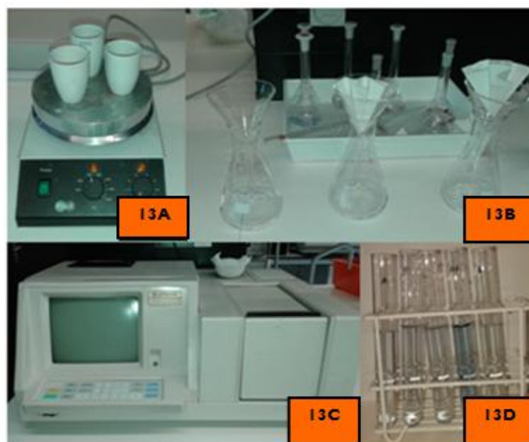
Figura 13: Etapas para a determinação do fósforo. 13A – Placa de aquecimento com cadinhos; 13B – Filtração das amostras; 13C – Espectrofotômetro; 13D – Amostras.
