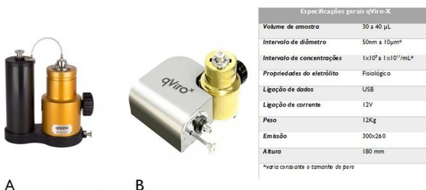
Figura 7- Imagem ilustrativa da instrumentação utilizada. A- qNano; B- qViro-X uma versão modificado do qNano com condições de pressão e tensão otimizadas para a medição da concentração de partículas; C- especificações operacionais do qViro-x.
