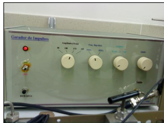
Figura 5 – Gerador de impulsos.
