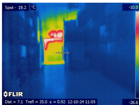
Figura 25 – Imagem termográfica de uma das portas da câmara de refrigeração da empresa A, vista do interior.
