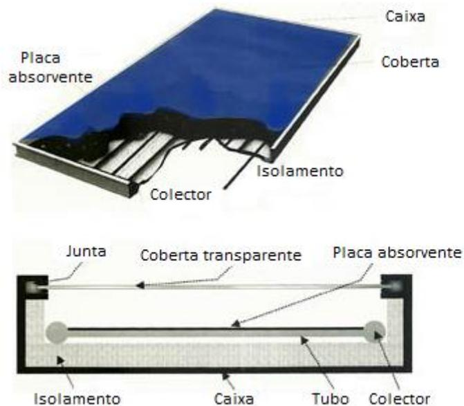
Figura 6. Esquema de um painel solar.
