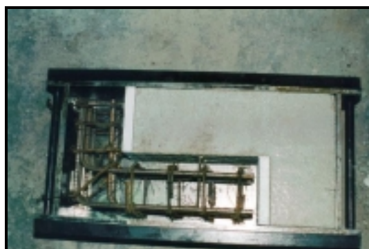
Fotografia 2.11 (f) - Molde com uma primeira metade de um provete push-off e a armadura da segunda metade.
