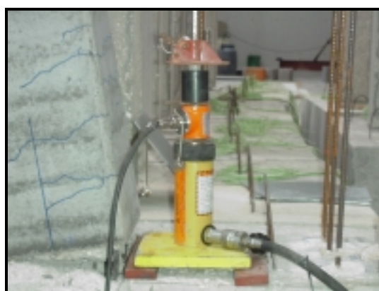
Fotografia 3.12 (e) - Realização do ensaio de arranque.
