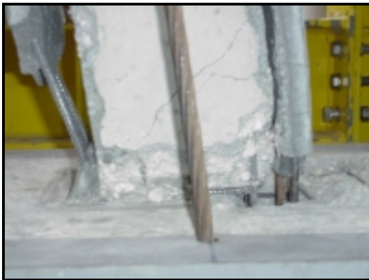
Fotografia 3.10 (e) - Encurvadura dos varões comprimidos da armadura longitudinal de reforço.
