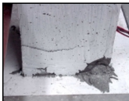
Fotografia 4.2 (d) - Fissuração da face comprimida do modelo M4G1.
