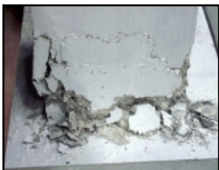
Fotografia 4.2 (c) - Fissuração da face comprimida do modelo M3G1.
