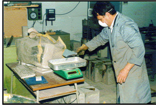
Fotografia 2.7 (b) - Pesagem na balança electrónica das sílicas de fumo (SIKACRETE HD).
