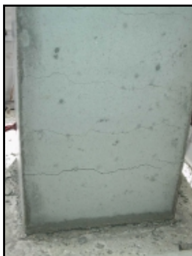
Fotografia 5.1 (g) - Fissuração da face traccionada do modelo M2G3.
