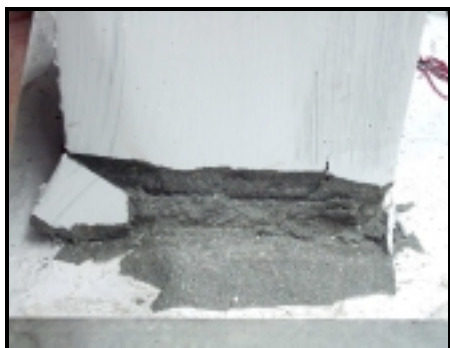
Fotografia 4.2 (e) - Fissuração da face comprimida do modelo M5G1.
