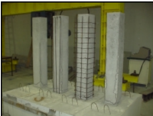
Fotografia 3.4 (e) - Montagem das cintas do reforço.
