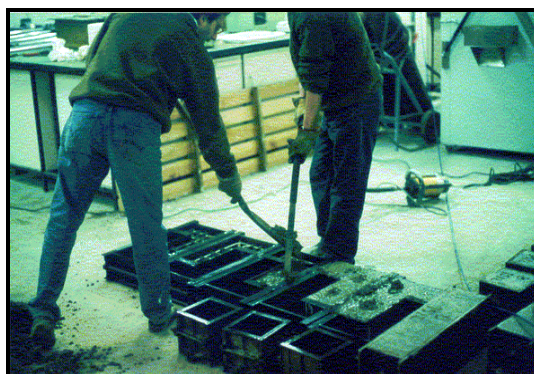
Fotografias 2.10 (c) - Betonagem de primeiras metades de provetes push-off .
