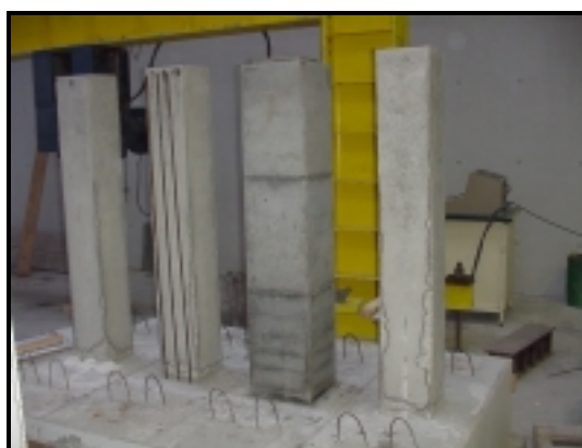
Fotografia 3.5 (f) - Modelo MIG0 descofrado.
