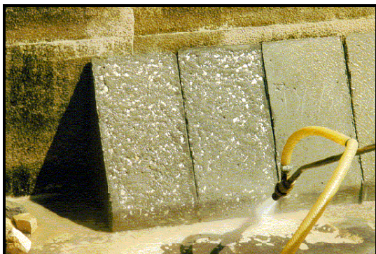
Fotografias 2.2 (c) - Preparação da superfície da interface com jacto de areia
