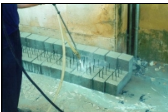
Fotografia 2.11 (e) - Tratamento da superfície da interface com jacto de areia.
