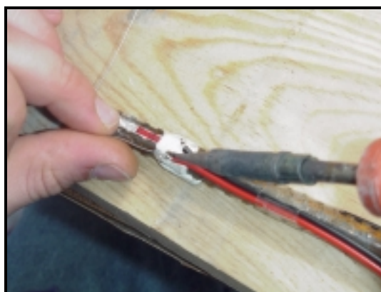
Fotografias 3.1 (b) - Soldadura dos fios eléctricos.
