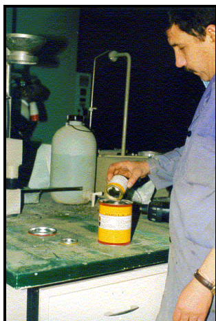
Fotografia 2.6 (a) - Adição dos componentes A e B do ICOSIT K 101 da SIKA.
