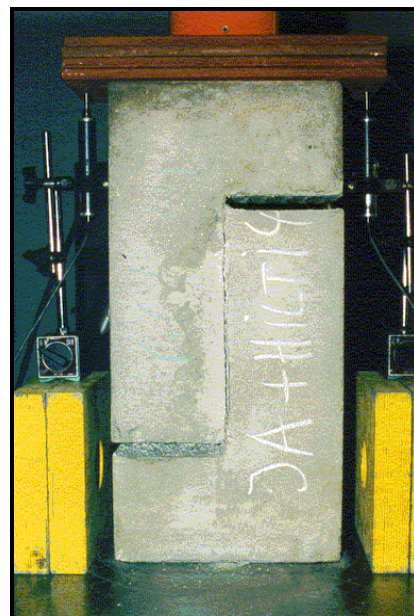
Fotografia 2.12 (b) - Instante do descolamento da superfície da interface.
