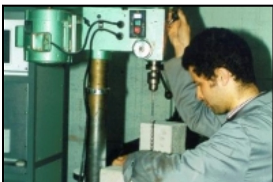
Fotografia 2.11 (a) - Execução dos furos num meio provete push-off .
