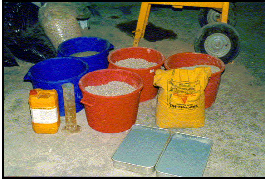
Fotografia 2.7 (a) - Componentes do betão das segundas metades dos provetes 30/100.
