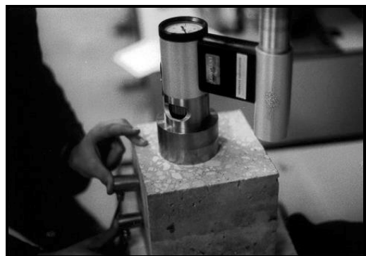
Fotografias 2.1 - (a) Ensaio de corte inclinado ( slant shear test ) e (b) Ensaio de tracção directa ( pull-off test ).
