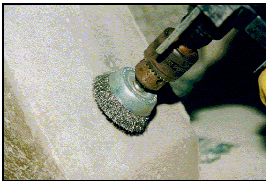
Fotografias 2.2 (a) - Preparação da superfície da interface com escova de aço.
