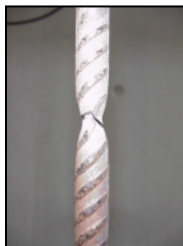
Fotografia 3.19 (c) - Rotura do provete.
