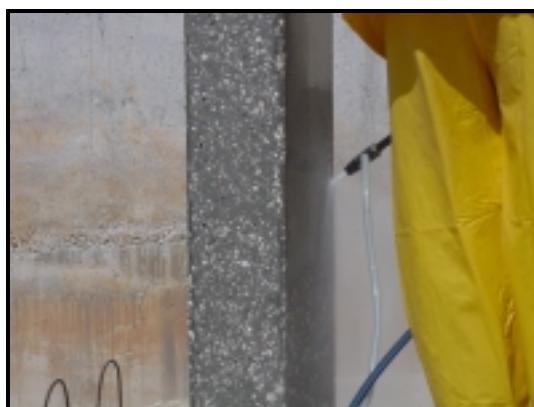
Fotografia 3.14 (a) e (b) - Execução do tratamento da superfície dos modelos com jacto de areia.
