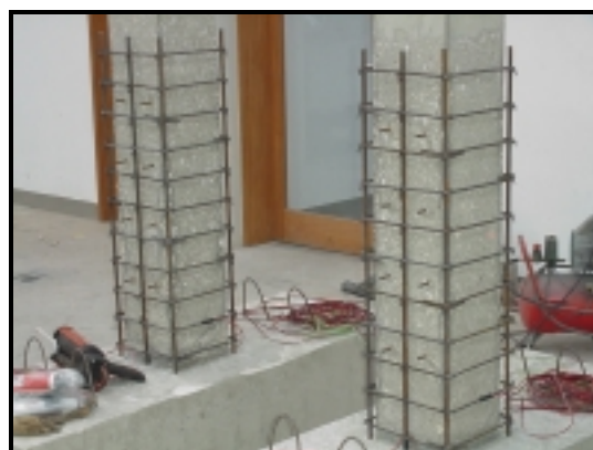
Fotografia 3.15 (d) - Modelos com os conectores aplicados.
