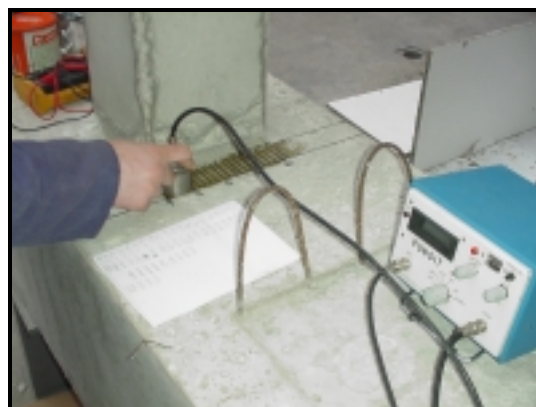
Fotografia 3.13 (b) - Detecção por ultra-sons da localização das baínhas.
