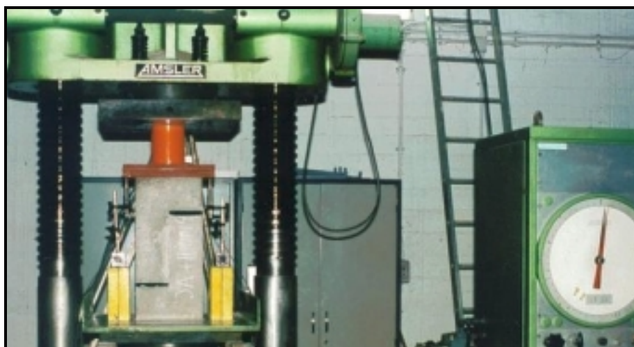
Fotografia 2.9 - Instalação de ensaio de um provete push-off .
