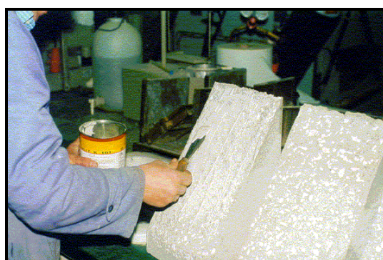
Fotografias 2.6 (c) - Aplicação à espátula da resina epóxida na superfície da interface de um provete slant shear
