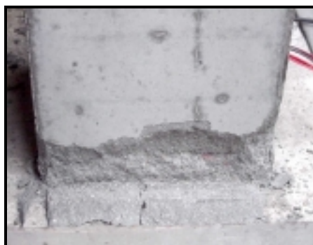
Fotografia 4.2 (g) - Fissuração da face comprimida do modelo M1G3.
