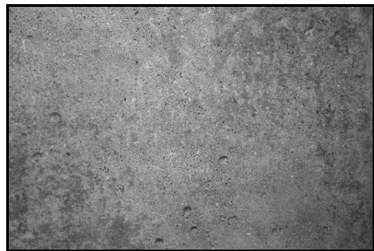
Fotografias 2.2 (a) - Preparação da superfície da interface com escova de aço.
