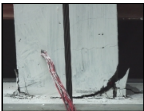
Fotografias 5.2 (e) - Fissuração da zona do encastramento do modelo M5G2.
