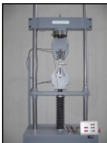
Fotografia 3.19 (a) - Ensaio de resistência à tracção de um provete de aço.
