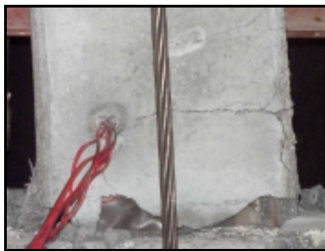
Fotografias 5.2 (b) - Fissuração da zona do encastramento do modelo M2G2.
