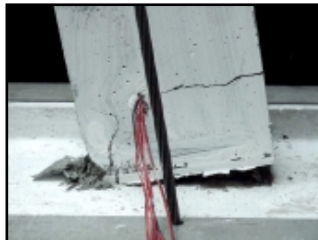
Fotografia 4.3 (d) - Fissuração da zona do encastramento do modelo M4G1.
