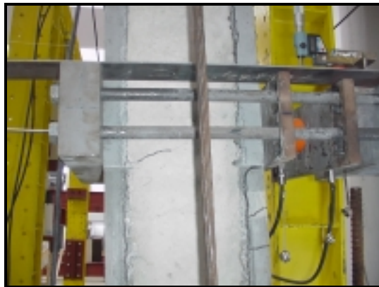
Fotografia 3.10 (f) - Ausência de fissuração na vizinhança da secção de aplicação da carga horizontal.
