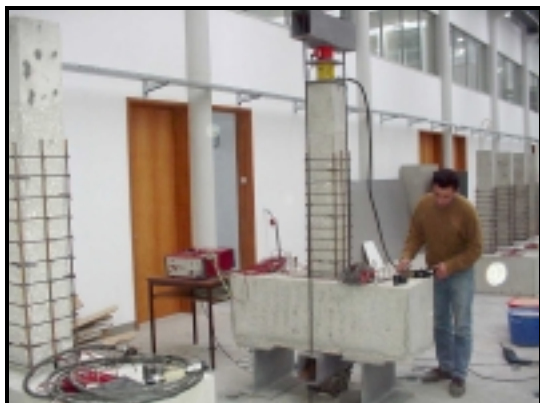
Fotografia 3.17 (a) - Aplicação do esforço axial num dos modelos do Grupo 3.
