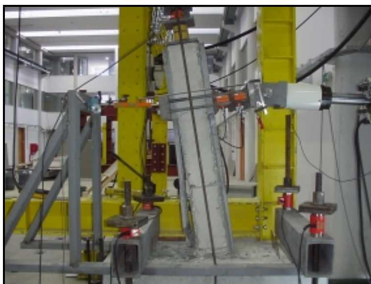
Fotografia 3.9 - Ensaio lento monotónico do modelo M2G0.
