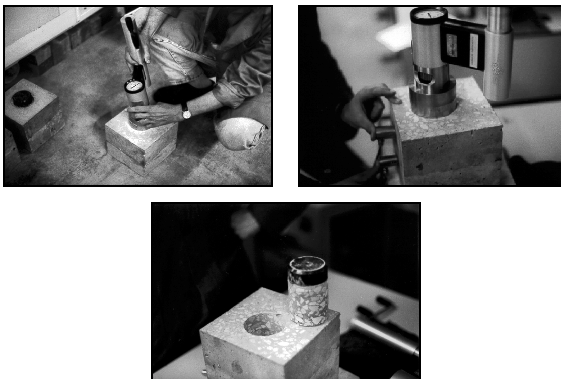
Fotografias 2.5 - (d) Ajuste do equipamento do ensaio pull-off ; (e) Ensaio pull-off e (f) Rotura pela interface de um provete pull-off .
