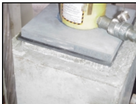
Fotografia 3.8 (e) - Ausência de escorregamento entre o modelo e o reforço.
