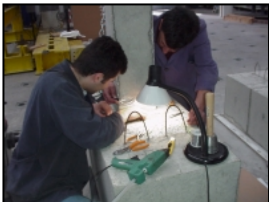
Fotografia 3.13 (d) - Reparação dos fios dos extensómetros danificados.
