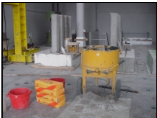
Fotografia 3.5 (a) - Misturadora de eixo vertical, sacos de SikaGrout e água.
