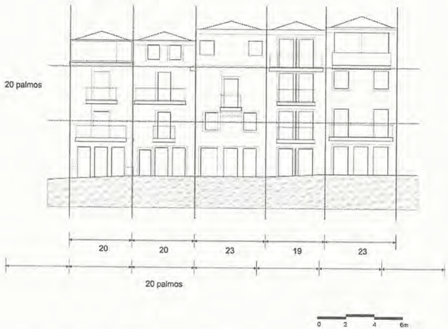
Fig. 12 - Análise algébrico-geométrica (sumária) do alçado de algumas casas do quarteirão de Valença assinalado na imagem anterior [I. COELHO, 2001].
