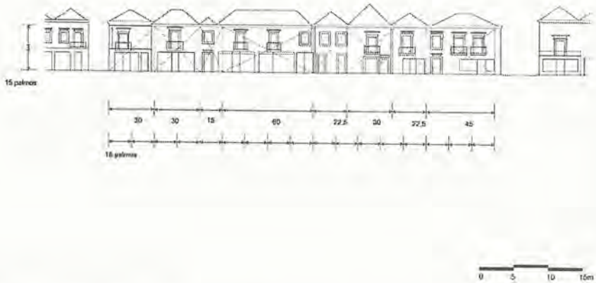
Fig. 10 - Análise algébrico-geométrica (sumária) do alçado de um quarteirão da antiga ribeira (Rua Dr. José Pires Padinha) de Tavira [P. BARÃO, 2001].
