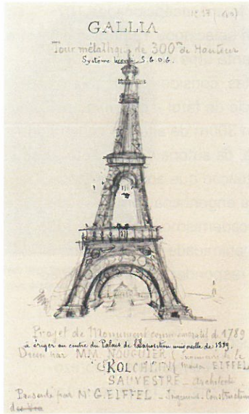
Figura 2. Gallia, torre metálica de 300 metros de altura. Projeto de monumento comemorativo do centenário de 1789, desenho do projeto elaborado em 1884 por Maurice Koeclin, Émile Nouguier e Stephen Sauvestre.
