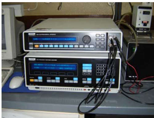
Figura 3.5 – Equipamento de EIS: analisador de frequência Solartron 1250 acoplado a uma interface electroquímica Solartron 1286.
