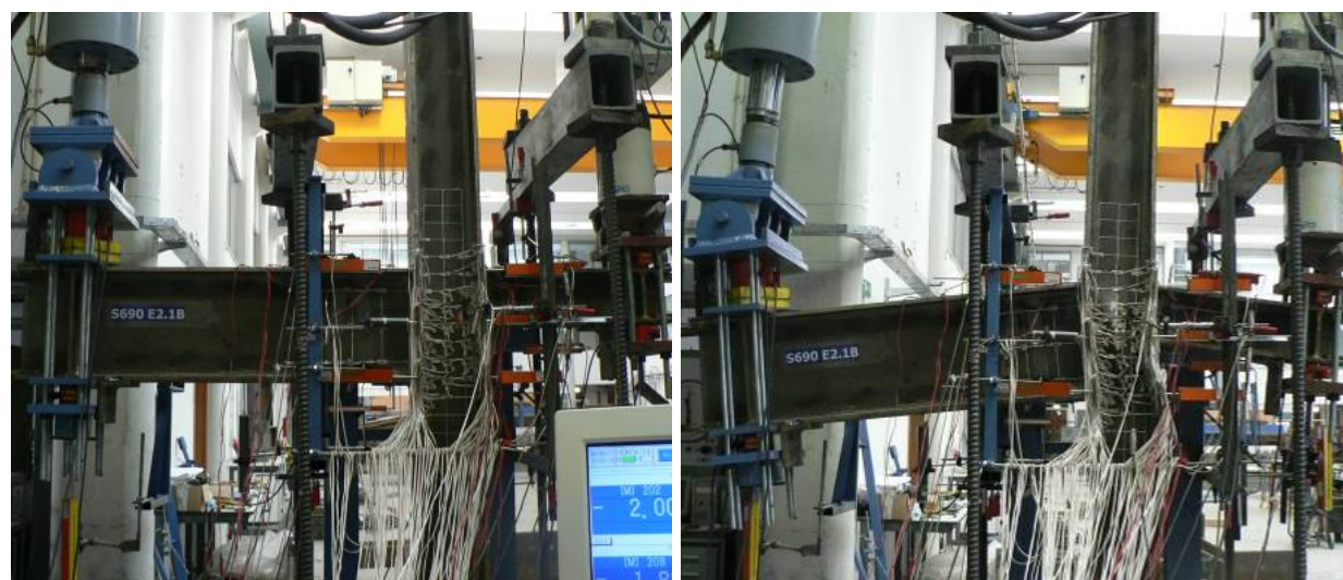
Figura 76 . Aspectos do conjunto antes e depois da realização do ensaio (S690E2B)
