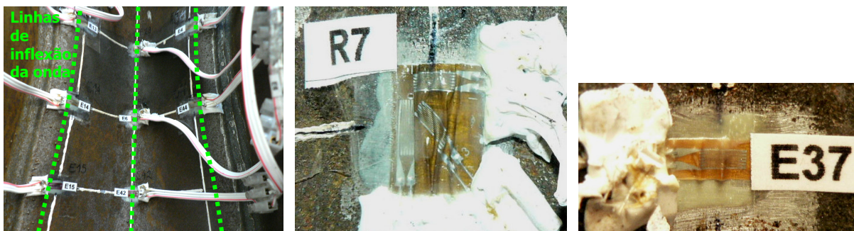
Figura 11 . Influência das grandes deformações nas leituras dos extensómetros
