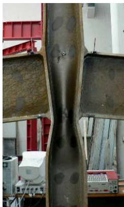
a) Deformação da junta
