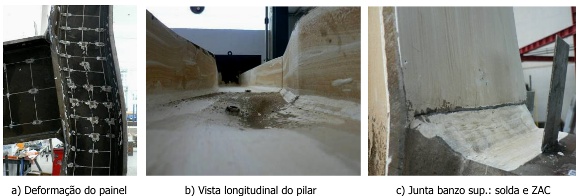
Figura 67 . Detalhes da deformação da estrutura no fim do ensaio (S690E1.2)
