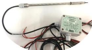
c) Sensor de velocidade do ar, Delta OHM HD 403.
