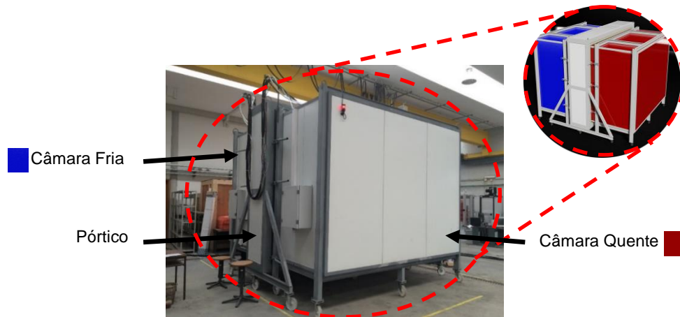
Figura 3. Fotografia e representação esquemática das câmaras climáticas da Guarded Hot Box usadas nos ensaios.
