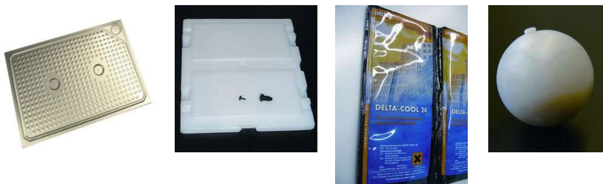
Fig. 3: Exemplos de macro cápsulas com PCM no seu interior [16,17]
