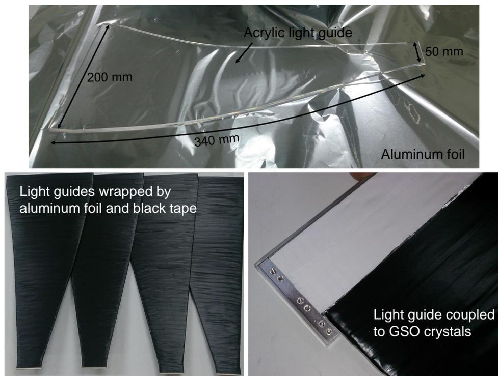
Figura 6.7: Fotografias de algumas das etapas do processo de construção das guias de luz utilizadas no protótipo.
