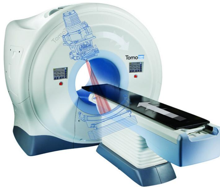
Figura 1.8: Unidade de tratamento de tomoterapia – TomoTherapy<sup>®</sup> [49]. O sistema consiste num linac instalado num anel e uma cama móvel. Durante o tratamento, é possível irradiar a partir de qualquer ângulo. A conjugação do movimento do linac e da cama permite a entrega de feixes em espiral, os quais podem ser úteis no tratamento de campos maiores.
