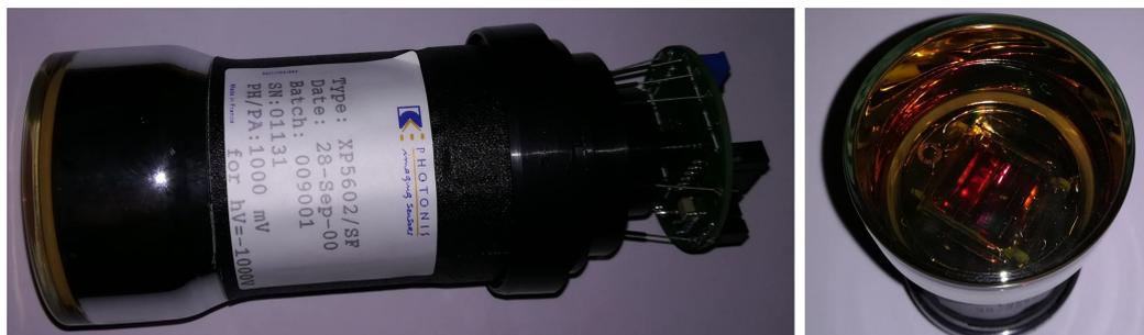
Figura 6.4: Fotografia do PMT utilizado na construção do protótipo.
