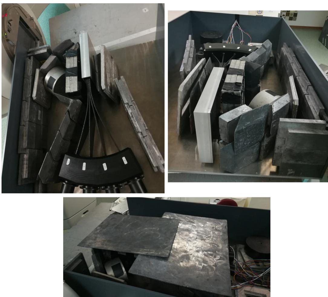
Figura 6.23: Vista de diferentes ângulos da configuração de blindagem utilizada para proteger o detetor da radiação de fundo que escapa da cabeça do linac.
