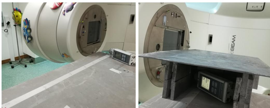
Figura 6.21: Montagem experimental utilizada para medir o equivalente de dose ao longo da direção perpendicular ao feixe, sem (à esquerda) e com blindagem (direita).
