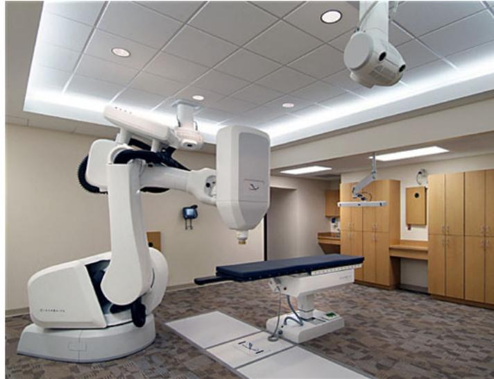
Figura 1.9: Sistema CyberKnife® [54]. O linac está montado num braço robótico, o que confere mais graus de liberdade na escolha dos portais para efetuar o tratamento. A monitorização de tumores móveis é realizada através de imagiologia externa (recorrendo a marcadores de infravermelho e respetivo sistema de câmeras montado no teto) e de imagiologia interna (utilizando fluoroscopia de raios X, com dois tubos de raios X montados no teto e dois painéis detetores instalados no chão).
