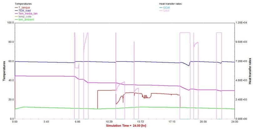
Figura C.1: Temperaturas e energia consumida auxiliar nas primeiras 24 horas do ano no sistema termossifão
