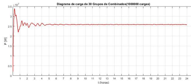
Figura 5.3: Diagrama de carga de 30 grupos de FrC simulado com MFBS com RNA
