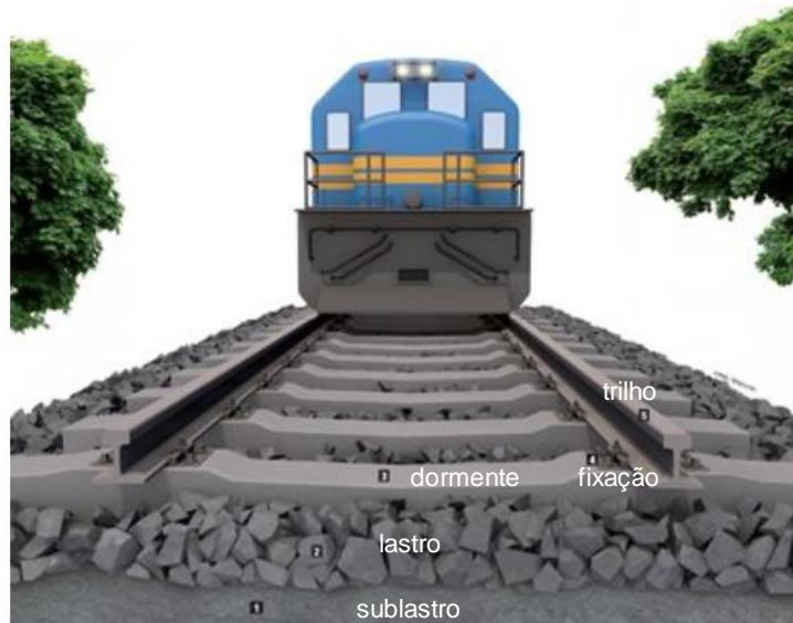
Figura 3-8 Componentes da superestrutura ferroviária (adaptado de Carvalho, 2013).
