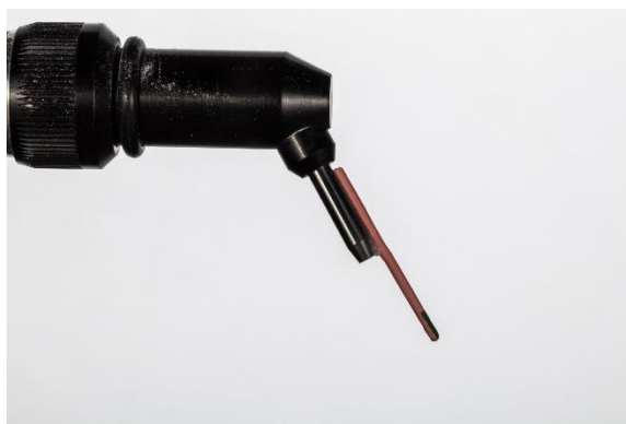
Fig. 1 Fotografia do jato de óxido de alumínio com calibração de distância a 1cm.
