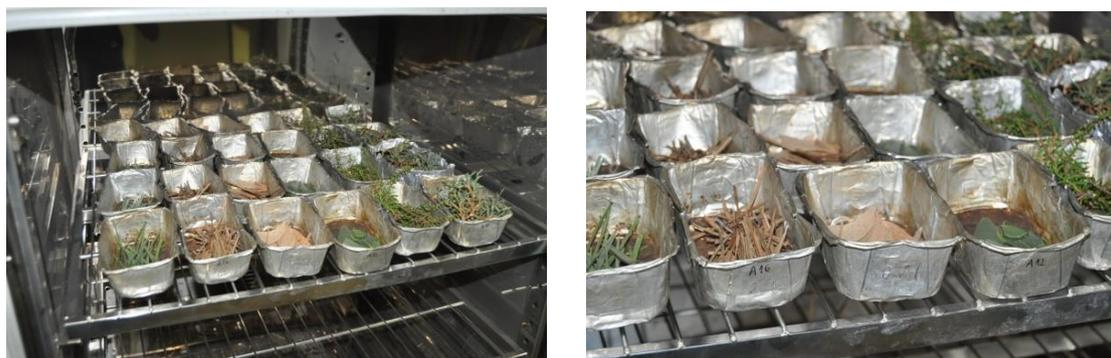
Figura 14 colocação das réplicas na estufa e aspeto geral da estufa de secagem no LEIF, Lousã. Foto: CEIF.
