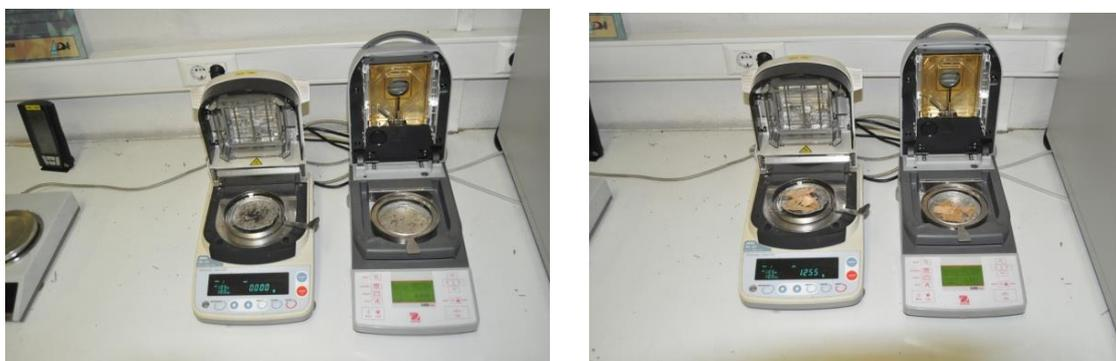
Figura 12 determinação do teor de humidade das espécies arbóreas mortas *Pinus pinaster* e *Eucalyptus globulus*, a partir do analisador do teor de humidade, Lousã. Foto: CEIF.
