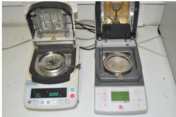
Figura 5 analisadores do teor de humidade AND ML-50 e MB45, utilizados pelo CEIF na Lousã. Foto: CEIF.
