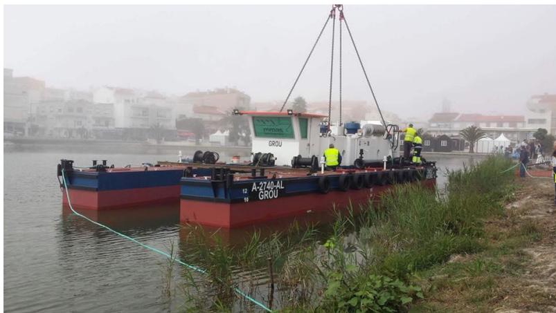
**Figura 20** - Draga em trabalho de desassoreamento da barrinha da Praia de Mira.
