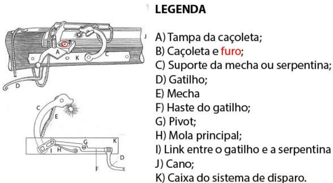
Fig.4: caracterização do sistema de disparo da espingarda de mecha.<sup>64</sup>
