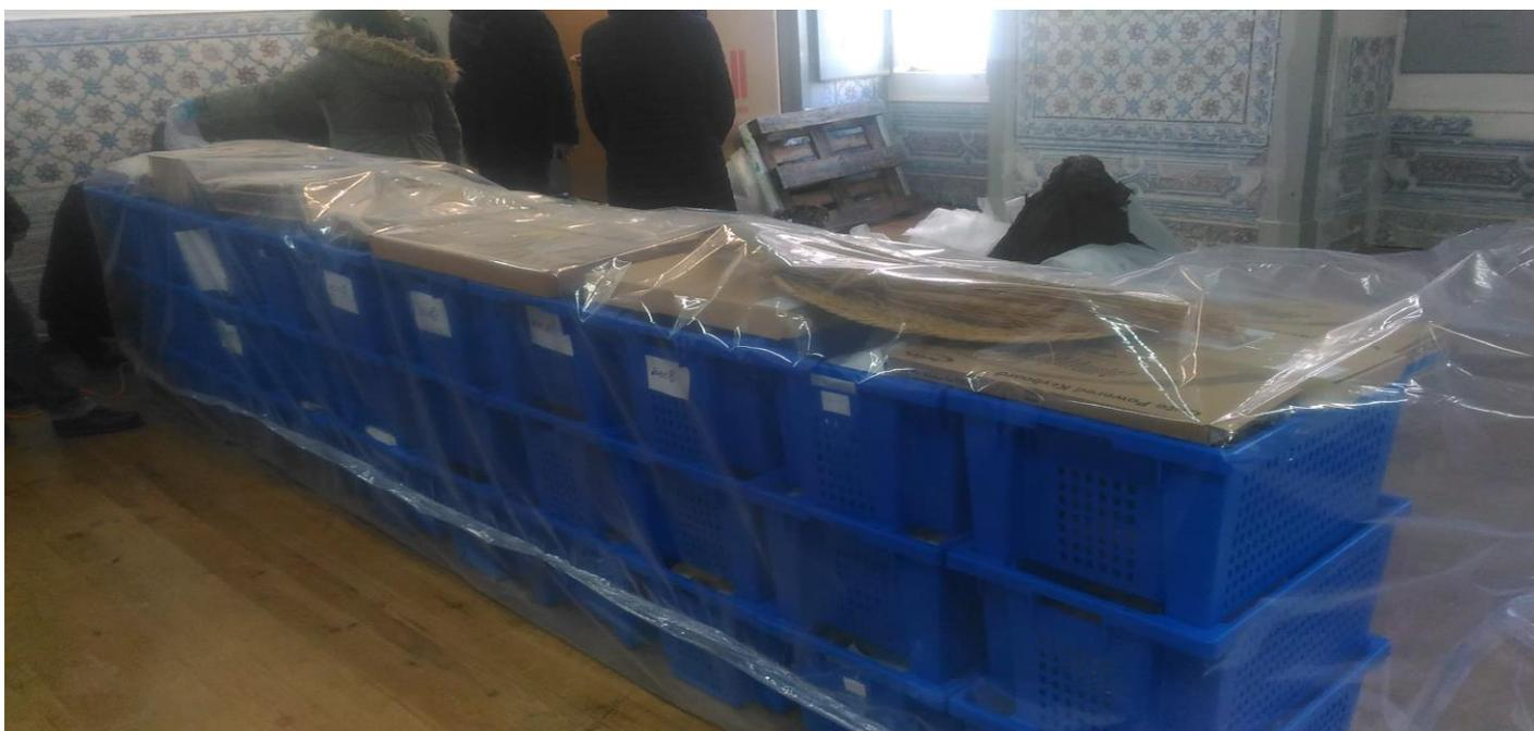
Fig.10: “Bolha” criada pela máquina da anoxia para desinfestação das peças museológicas. “Bolha” criada numa sala grande para um melhor organização e arejamento. Foto de Vítor Torres.
