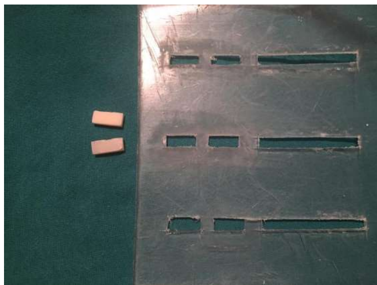
Figura 3. Espécimes de resina composta e molde respetivo.
