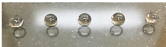
Figura 4.3 – Medição do ângulo de contacto com água destilada num filme de Sylgard®.
