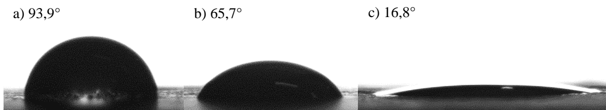
Figura 4.1 – Medição dos ângulos de contacto com a) água destilada, b) diiodometano e c) n-hexadecano, com o respetivo valor obtido, para amostras de luvas simples.
