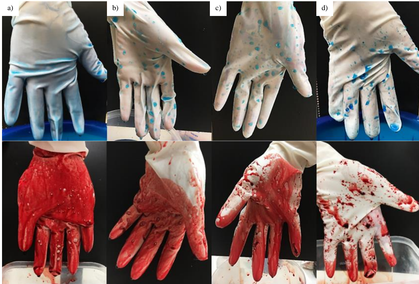
Figura 4.22 – Testes visuais de repelência com a) luvas sem tratamento e luvas revestidas com b) MTMS, c) DMDMS e d) TMMS, imersas numa solução aquosa com azul de metileno (em cima) e em sangue de porco (em baixo).
