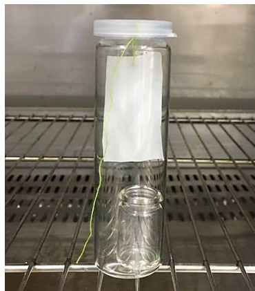
Figura 3.4 – Montagem utilizada para o contacto do vapor de HMDZ com amostras de luva previamente funcionalizadas com ácido peracético.
