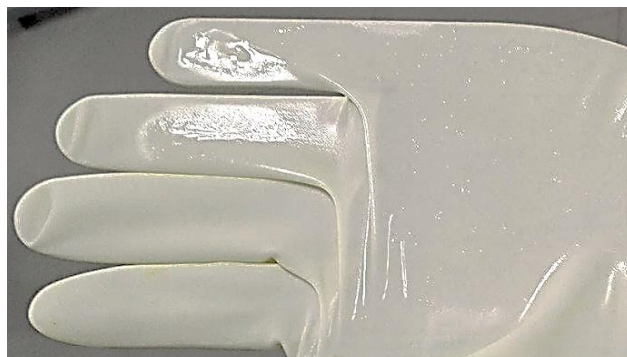
Figura 4.4 – Luva simples revestida com a solução de Sylgard ® 184, mostrando a reticulação muito incompleta à sua superfície.
