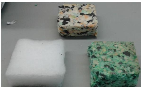
Figura 4.16 – Amostra de fibra de poliéster (à esquerda) e aglomerado de espumas.
