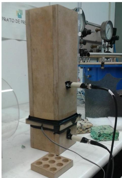
Figura 4.12 – Equipamento semelhante ao proposto por Dragonetti et al (2011) com isolamento em todos seus contornos exteriores de modo a evitar as fugas de ar.
