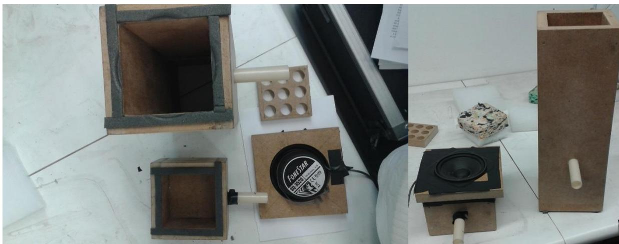
Figura 4.11 – Lado esquerdo: vista das cavidades superior e inferior dotadas de fitas de calafetagem no seu contorno de assentamento e placa perfurada com altifalante adaptado. Lado direito: vista da cavidade inferior sobre a qual está inserida a placa conjugada com o altifalante e a cavidade superior que assenta sobre a mesma.
