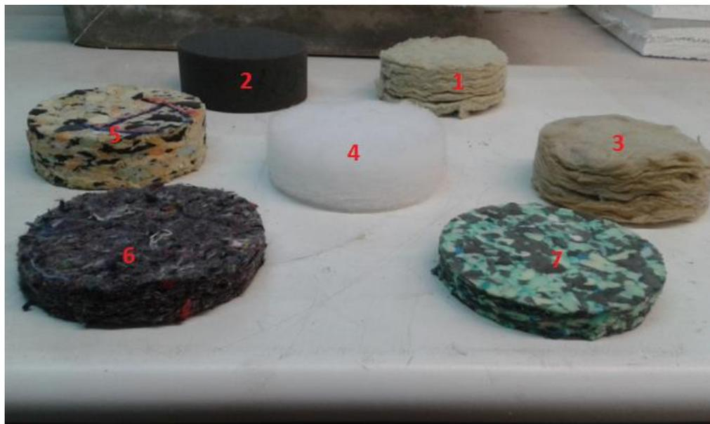
Figura 3.9 – Amostras porosas numeradas: 1 – Lã de rocha de 4 cm; 2 – Espuma de poliuretano; 3 – Lã de rocha de 3 cm; 4 – Fibra de poliéster; 5 – Aglomerado de espumas; 6 – Tecido; 7 – Aglomerado de espumas.
