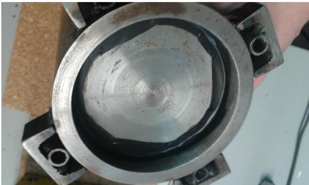
Figura 4.2 – *Backing Plate* com frincha vedada por auxílio de fita isolante.
