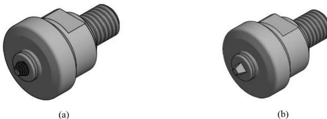
**Figura 3.1.** (a) Ferramenta Cónica Roscada Progressiva; (b) Ferramenta Piramidal Progressiva (adaptada de Melle 2015).
