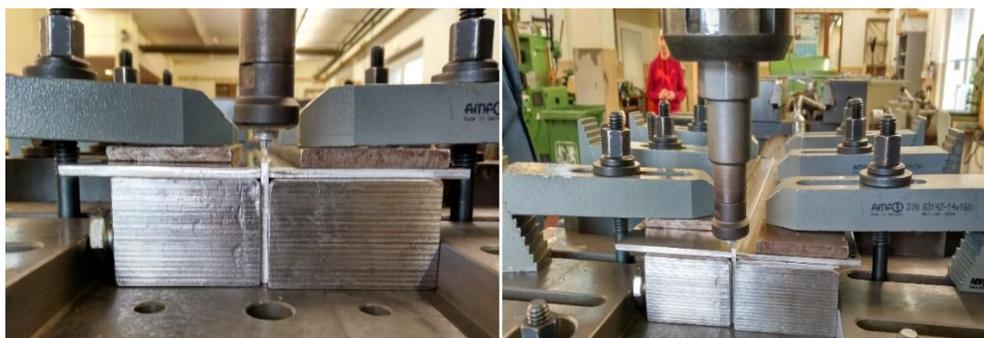
**Figura 3.2.** Montagem concebida para a realização das soldaduras.
