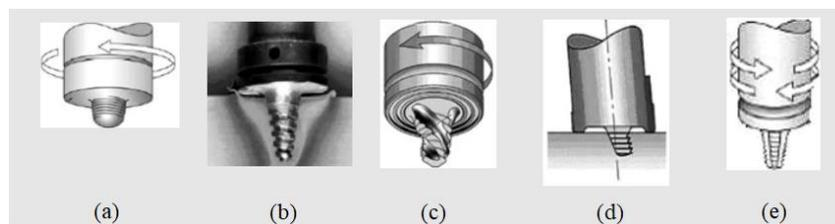
**Figura 2.3.** Várias geometrias do pino: (a) Cilíndrico com rosca, (b) Cônico com rosca, (c) Riscado com rasgos em forma de hélice, (d) Cilíndrico inclinado com rosca, (e) Cônico com rosca (adaptada de Nandan et al. 2008).
