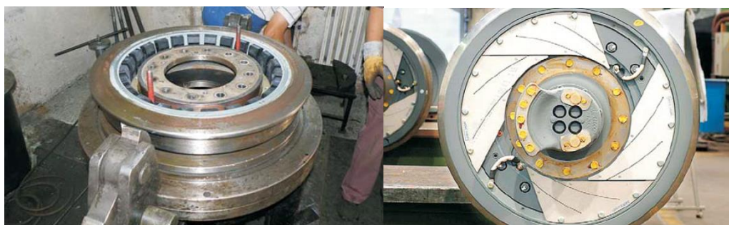
Figura 3.34. Rodas resilientes (esquerda) e rodas amortecidas (direita) (Lakušić & Ahac, 2012)
