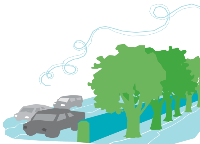
Figura 3.13. Árvores para melhorar a performance acústica de barreiras (HOSANNA partners, 2013)
