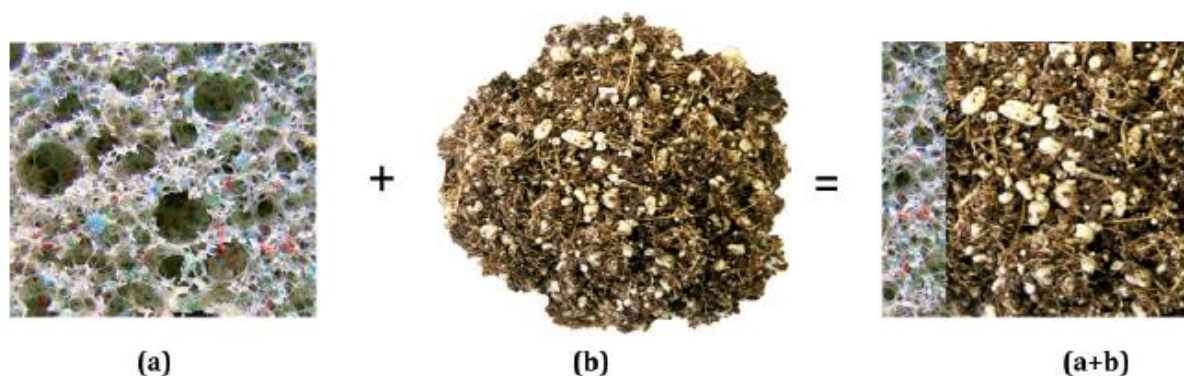
Figura 3.1. Material reciclado utilizado no aumento da absorção sonora e retenção de solo em barreiras acústicas vegetais (HOSANNA partners, 2013)
