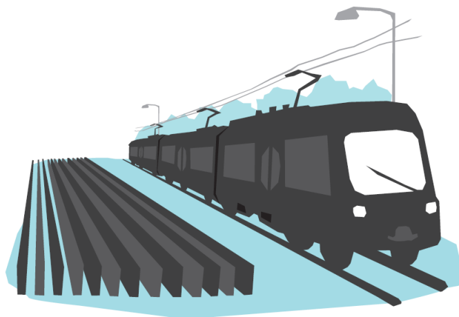
Figura 3.27. Ilustração de uma solução de paredes paralelas baixas na mitigação de ruído ferroviário (HOSANNA partners, 2013)
