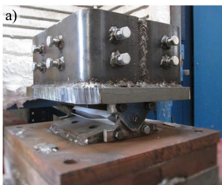
Figura 3.3 – a) Apoio rotulado; b) Apoio semi-rígido; c) Sistema de bloqueio das colunas no interior dos apoios.
