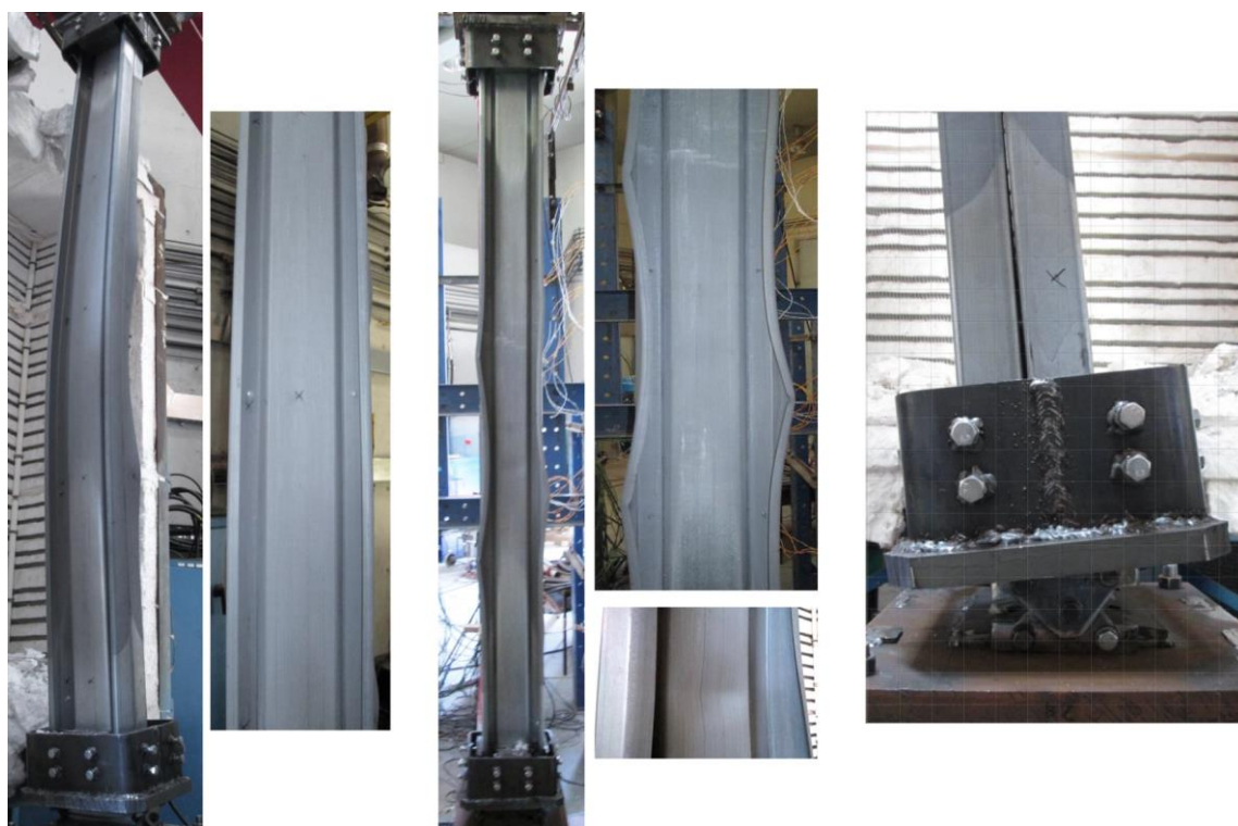
Figura 3.17 – Modos de encurvadura observados para as colunas 2 \Sigma _PP.
