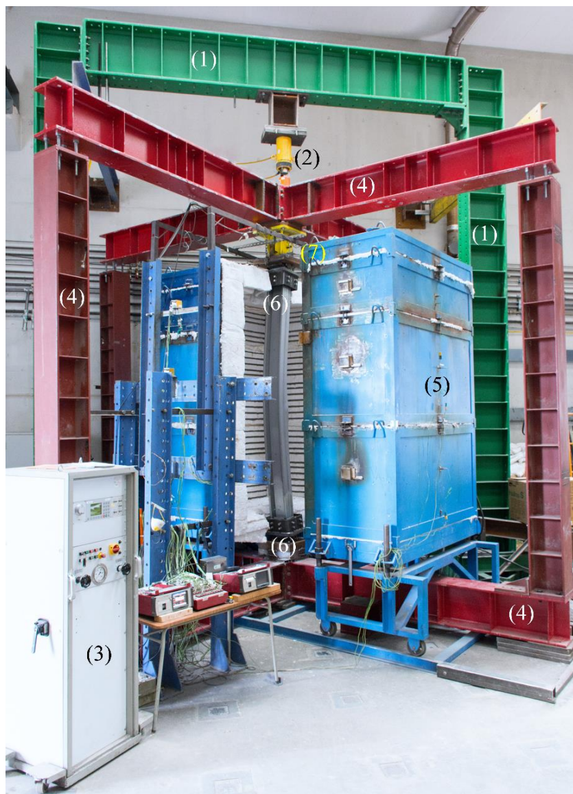
Figura 3.2 – Sistema experimental de ensaio das colunas de AEF em situação de incêndio.
