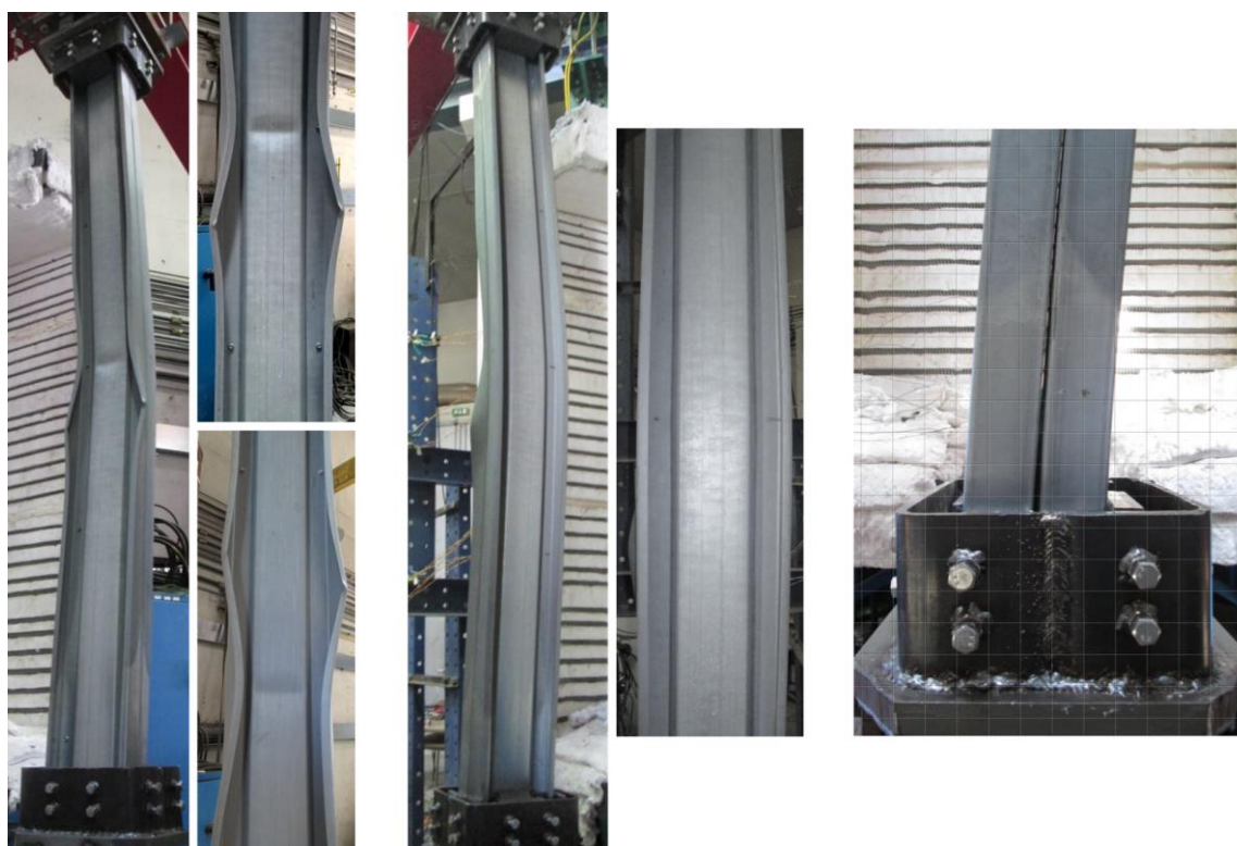
Figura 3.16 – Modos de encurvadura observados para as colunas 2\Sigma _SR.
