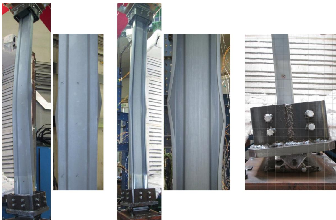
Figura 3.15 – Modos de encurvadura observados para as colunas \Sigma _PP.
