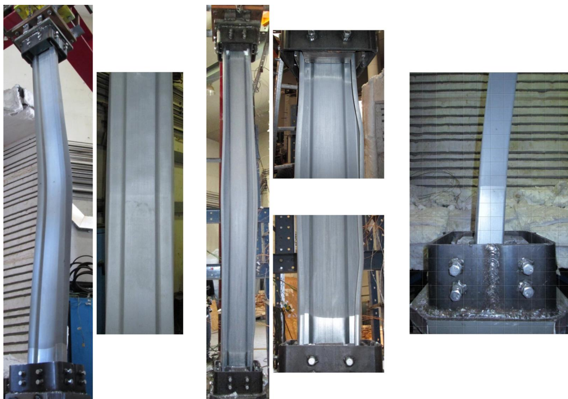
Figura 3.14 – Modos de encurvadura observados para as colunas \Sigma _SR.
