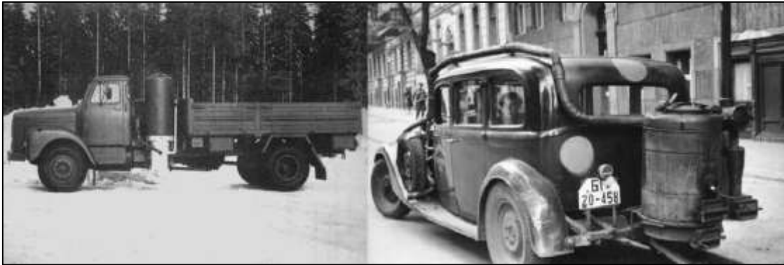
Figura 12 - Veículos movidos a gaseificadores de biomassa durante a Segunda Guerra Mundial. (Biomass Industrial Innovative Projects, 2016)
