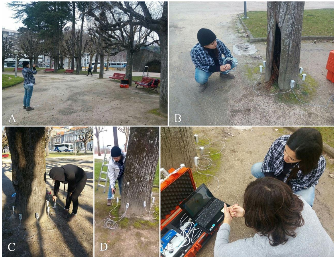
Figura 13 - Técnica de tomografia em árvores. A. Estimativa de altura. B. Instalação do equipamento. C. Realização de teste dos sensores. D. Execução da tomografia. E. Registo dos dados no software. Fotografias: Ana Luísa Carvalho. Data de obtenção das imagens: Dez/2015.
