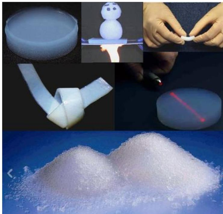
Figura 17. Representação de aerogéis constituídos à base de sílica.
