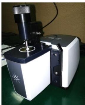
Figura 19. Equipamento de análise por FTIR.
