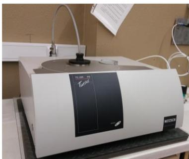
Figura 25. Equipamento da análise termogravimétrica.
