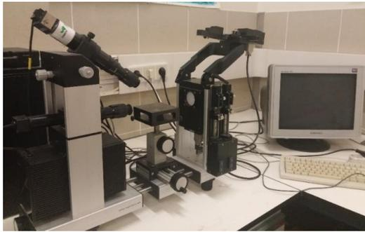
Figura 21. Equipamento de análise do ângulo de contacto.
