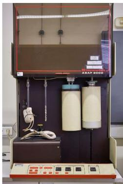
Figura 23. Equipamento de avaliação de áreas de superfície – *ASAP 2000*.
