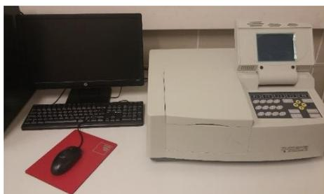
Figura 29. Espectrofotómetro UV-Vis utilizado na técnica colorimétrica de MBAS.
