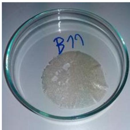
**Figura A4** – Aspeto do RPI de B<sub>2</sub>ImCl/NIPAM, em que se utilizou agitação mecânica do Ultra Turrax®, após a água evaporar.
