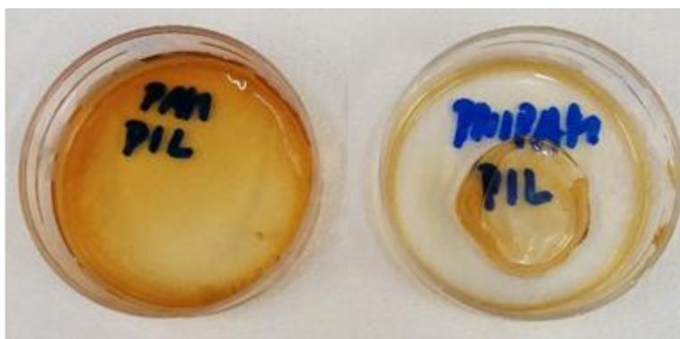
**Figura A1** – Aspeto da primeira tentativa de RPIs, após a colocação na estufa a 70°C, a amostra identificada com PAM PIL é o RPI de BVimCl/AAm e a amostra identificada com PNIPAM PIL é o RPI de BVimCl/NIPAM.
