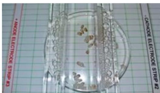
**Figura 22** – Aspeto da amostra COP\_100/0\_R2 no final do ensaio preliminar de sorção com aplicação de campo elétrico (antes da troca do anião Cl<sup>-</sup> pelo [(Tf<sub>2</sub>N)<sup>-</sup>]).
