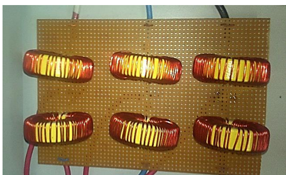
Figura F.3: Bobinas utilizadas como filtro do lado AC.
