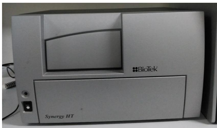
Figura 11 - Equipamento para ler testes de ELISA.
