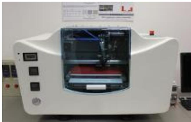
Figura 8 – Bioextrusora do CDRSP – IPL (retirado de [35]).
