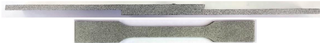
Figura 3.8. Preparação das superfícies dos provetes para medição com DIC.
