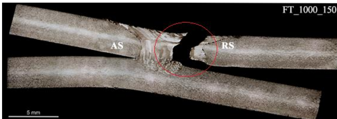
Figura 4.17. Exemplo da zona de rotura para uma amostra realizada com menor passo de soldadura.
