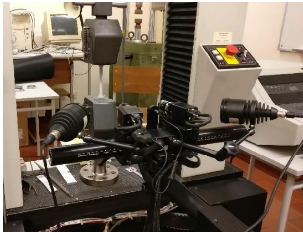
Figura 3.7. Extensômetro ótico ARAMIS Optical 3D Deformation & Strain measurement system utilizado.
